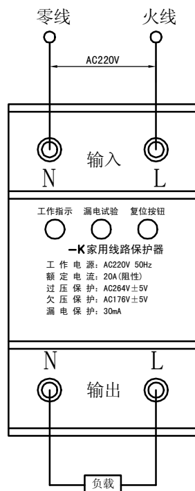
保护器单独使用接线图
